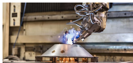
Die Laserzell 1005 nutzt Elfim für unterschiedliche Laseranwendungen wie 2- und 3-D-Schneiden und Schweißen aber auch für das LMD-Verfahren.
