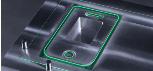
Smartphone-Display: Chemisch vorgespannte Gläser wie etwa für Tablets und Handys kommen auch bei Uhren in Mode. Pikosekundenlaser schneiden solche Gläser wirtschaftlich und präzise.
