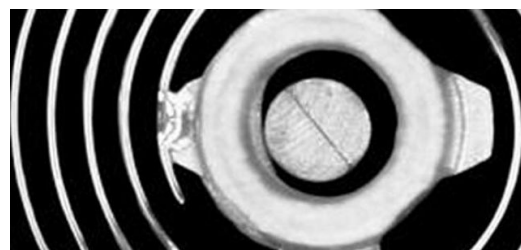
Der Schweißpunkt hat einen Durchmesser von 0,2 Millimetern
