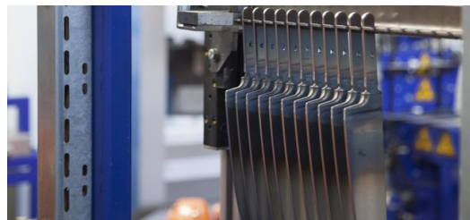
Nach dem Konturschneiden warten die Klingen auf das Stiften, Schleifen und Härten. Bild: Ralf Kreuels
