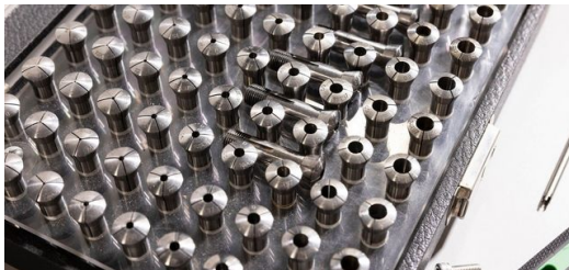
Dank hochflexibler Werkzeuge dauert das Einrichten der Teilehalterung und das Ausrichten der Optiken weniger als fünf Minuten: Hier die Werkzeuge zur Teilehalterung.
