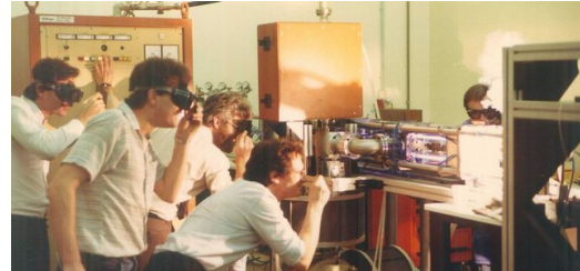
1985 baut TRUMPF seinen ersten eigenen CO 2 -Laser, den TLF 1000. Er hat eine Laserleistung von 1 Kilowatt.
