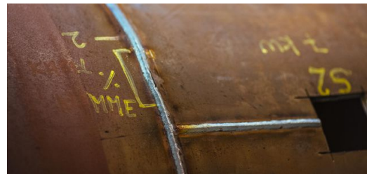
Nähte mit einer Schweißtiefe von bis zu 25 Millimeter: Mit einem 32-Kilowatt-Laser simulieren die Ingenieure des LWT Laserhybridschweißprozesse für die maritime und Offshorewindkraftindustrie. Foto: Kasper Fladnose
