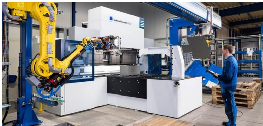
Die neue Schwenkbiegemaschine TruBend Center 7020 hat die Produktion des Feldofens erst möglich gemacht. Nur mit dieser Anlage konnte das Team bei Kuipers den relativ großen Brennraum von 333 Millimetern automatisiert biegen.
