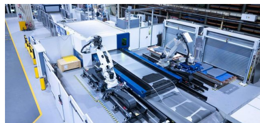
Die TruLaser 8000 Coil Edition in der Gesamtansicht: Auf diesem Bild ist zu erkennen, wie viel weniger Blechabfall übrigbleibt, wenn Fendt vom Coil
