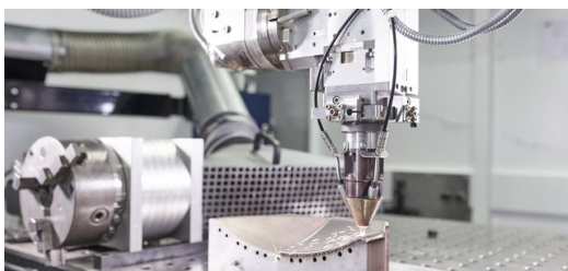
Die hier gezeigte LMD-Technologie eignet sich in der Luft- und Raumfahrt für die Reparatur großer Bauteile. (Quelle: TRUMPF / Claus Morgenstern).
