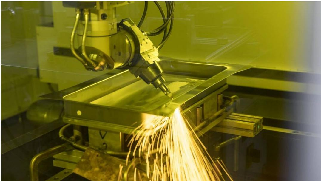
Tiefziehen ist eines der wichtigsten Herstellungsverfahren bei Rieber. Doch danach braucht es ein flexibles Werkzeug, um vor dem Fügen der tiefgezogenen Bauteile, die Ränder präzise abzuschneiden. Dafür steht die TruLaser Cell 7040 mit einem integrierten Scheibenlaser TruDisk 3001 in der Fabrikhalle von Rieber.
