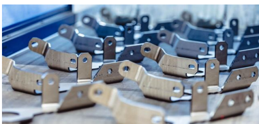
In der eigenen Blechfertigung verarbeitet MERZ im Dreischichtbetrieb täglich zwischen zehn und 15 Tonnen Dünnsblech. Eine hohe Teilevarianz bei Stückzahlen von eins bis 1.000 sowie ein hoher Termindruck sind Herausforderungen, die zum Arbeitsalltag gehören.
