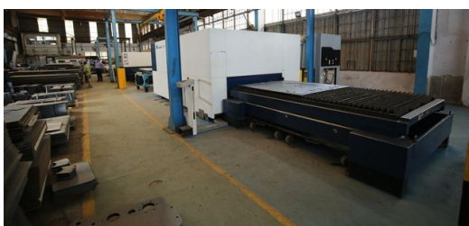
<p>Leichtbau benötigt nicht unbedingt hochfeste Stähle: JBM nutzt diese TruLaser 1030, um Profile für Busse herzustellen.</p>
