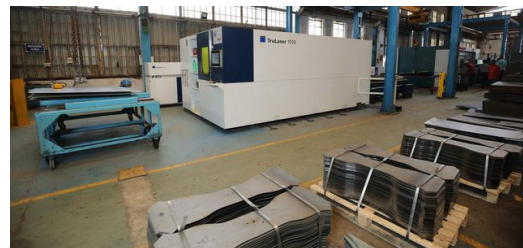
<p>JBM nutzt die TruLaser 1030 Maschinen seit mehreren Jahren für das Schneiden von Blechen.</p>
