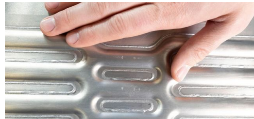
Beim von BENTELER entwickelten Faltkastenkonzept für ein Batteriegehäuse aus Edelstahl sorgt die patentierte TRUMPF Lösung BrightLine Weld auch im schnellen Serienbetrieb für eine spritzerfreie Bearbeitung und hochfeste gas- und heliumdichte Schweißnähte.
