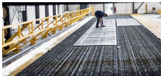
<span style="line-height: 115%; font-family: "Arial", "sans-serif"; font-size: 11pt;">Da der Tisch der Laseranlage ist ebenerdig ist, lassen sich die Bleche gut und einfach einbringen (Bilder: Norbert Voskens).</span>
