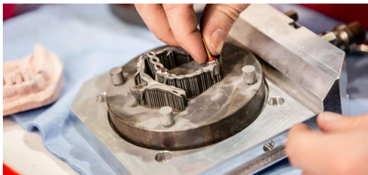
<p>In der TruPrint 1000 wird die Teleskopkrone aus dem Pulverbett aufgebaut. Die Kronen sind bis auf ein minimales Übermaß an den Innenseiten schon nahezu perfekt an die Geometrie des Primärteiles angepasst. (Bild: Steffen Müller-Klenk)</p>
