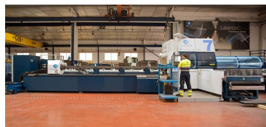
Neben 2D-Laserschneiden, Biegen und Gravieren, ist Lasercor auch Spezialist für Laser-Rohrschneiden. Bearbeitet werden neben Stahl- und Edelstahl auch Aluminium, Messing und Kupfer. (Pototo Diez)
