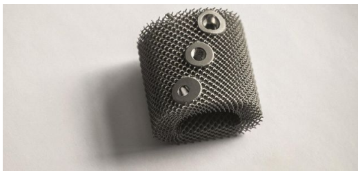
Prototyp für Cages aus dem 3D-Drucker: Lange war die Versteifung der Wirbelsäule das letzte Mittel beim Bandscheibenvorfall. Doch mit 3D-gedruckten Cages lässt sich die natürliche Höhe des Bandscheibensegments und damit die schmerzfreie Beweglichkeit wieder herstellen
