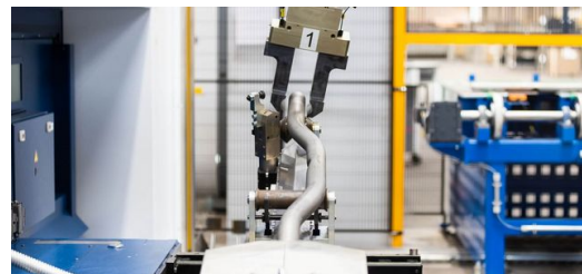
Die Anlagen im Maschinenverbund werden automatisiert von einem Robotersystem bedient, das die Teile automatisiert von einem Bearbeitungsschritt zum nächsten transportiert.
