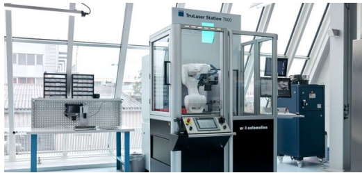
Effizientes Duo: Am schweizerischen Standort Widnau schweißt der Endoskop-Hersteller Karl Storz Okulare auf einer TruLaser Station 7000. Eine mobile Roboterzelle übernimmt das Be- und Entladen der Bauteile.
