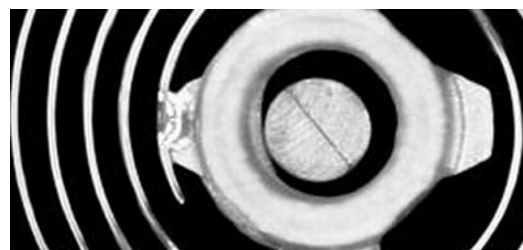
Der Schweißpunkt hat einen Durchmesser von 0,2 Millimetern
