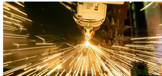
Der Laser einer TRUMPF Schneidmaschine erzeugt schräge Schnittkanten an den Konturen des Bauteils, sogenannte Fasen.
