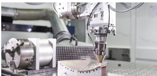
<p>Die hier gezeigte LMD-Technologie eignet sich in der Luft- und Raumfahrt für die Reparatur großer Bauteile. (Quelle: TRUMPF / Claus Morgenstern). </p>
