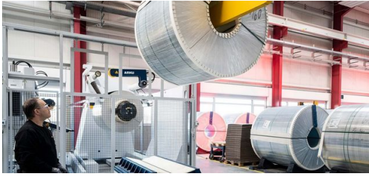
Maschinenbediener Martin Müller hievt ein 16-Tonnen-schweres Alu-Coil in die Beladezone der TruLaser 8000 Coil Edition von TRUMPF.
