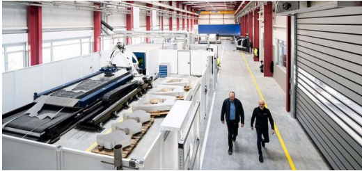
Die 34 Meter langen Laserblanking-Anlage von TRUMPF spart Rohmaterial und rund 4000 Tonnen CO 2 pro Jahr.
