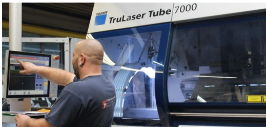
Der Maschinenbediener bekommt das fertige Programm auf sein Terminal, um das Gewinde ins Rohr zu schneiden.
