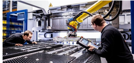
Bei Autz + Herrmann werden vorwiegend dünne Bleche verarbeitet. Die Niederdruck-Saugnapfe der Starmatik Roboterautomatisierung nehmen Platinen besonders materialschonend auf.
