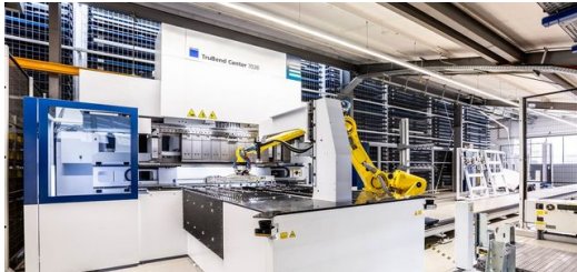
Die TruBend Center 7020 mit Starmatik Roboterautomatisierung ist an das vollautomatische STOPA Lager angeschlossen. Nur für die Bereitstellung neuer und den Abtransport beladener Paletten sind Mitarbeiter notwendig.
