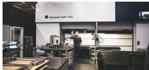
„Bei uns sind die Nebenzeiten manchmal länger als die Schnittzeiten. Das macht das schnelle Rüsten so wichtig“, sagt Fabian Renz von Rieber. Der Vorteil der [TruLaser Cell 7040](#): Sie bietet zwei flexible Stationen, so dass der Bediener gleichzeitig rüsten und fertigen kann.
