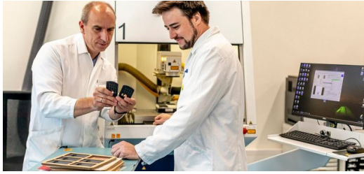
Einheitliche Verläufe sind für MED-EL das A und O. Ein hoher Kontrast ist dafür ausschlaggebend, denn er gewährleistet eine gute Lesbarkeit. Die TruMark Laser meistern diesen Job zuverlässig.
