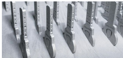
Das 3D-Druck-Verfahren erlaubte es den jungen Ingenieuren von UrbanAlps, die Form von Schlüsseln völlig neu zu denken.
