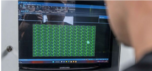
<p>Die Option CoolLine garantiert beim Laserschneiden eine konstante Temperatur. „Damit können wir Teile viel enger verschachteln und sparen so Material“, freut sich Denis Lozusic.</p>
