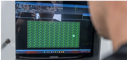
Die Option CoolLine garantiert beim Laserschneiden eine konstante Temperatur. „Damit können wir Teile viel enger verschachteln und sparen so Material“, freut sich Denis Lozusic.
