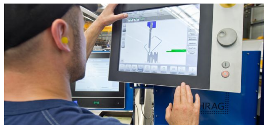
Über den hochauflösenden 17-Zoll-Color-Touchscreen-Flachbildschirm der Maschinensteuerung lassen sich 2D- und 3D-Programmierungen ebenso
