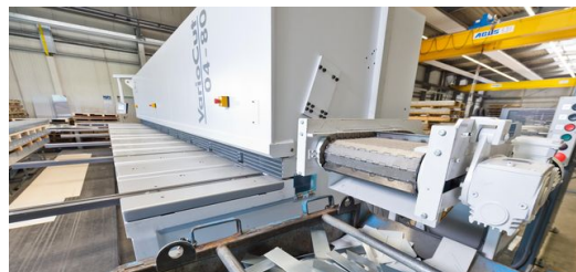
Eine an der EHT VarioCut angeschlossene Schneideanlage, zerteilt Schrott in kleine Stücke.
