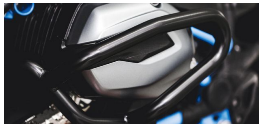
<p>IBEX hat sich das Ziel gesetzt, alles rund ums Motorrad aus Blech zu fertigen. Zum Produktportfolio gehört zum Beispiel dieser Sturzbügel.</p> – Marlen Mieth
