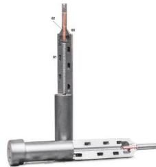
Zwei additive Verfahren formen den Metallstift im Spritzgusswerkzeug: Der 3D-gedruckte Stahlkörper verfügt über Kühlkanäle (1) und enthält einen rasch abkühlenden Kupferstift (2), der mittels LMD umschichtet und mit dem Stahlkörper verbunden wird (3). (Bild: Philipp Reinhard)
