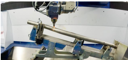
Mit der 3D-Laseranlage TruLaser Cell 8030 von TRUMPF lassen sich präzise Konturen ausschneiden, die vor dem Biegen nicht eingebracht werden können, weil sie sich sonst verformen würden.
