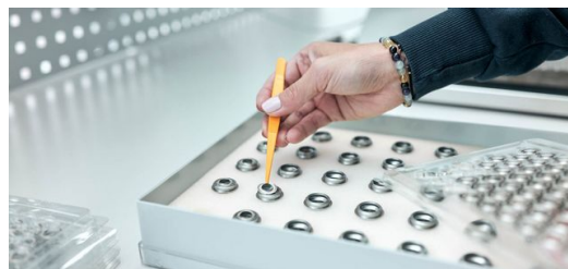
Vorbereitung für den Schweißprozess: Das Platzieren der Linsen auf den Edelstahlhülsen ist nach wie vor Handarbeit.
