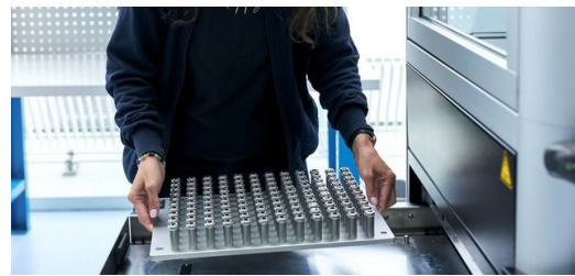
Die Automatisierungszelle ist mit vier Schubladen ausgestattet. 960 Bauteile haben darin Platz. Sie werden parallel zum Schweißprozess be- und entladen.
