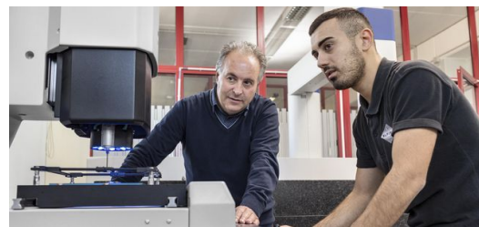
Ersatzteile für Oldtimer sind rar. Per LMD-Verfahren lassen sie sich kostengünstig rekonstruieren. Dafür scannen die Experten bei Elfim die Ersatzteile ein. Bild: Antonio & Roberto Tartaglione
