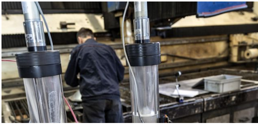
Zusammen mit einem Pulverförderer eignet sich die Laserzell 1005 von TRUMPF auch hervorragend fürs Laserauftragschweißen. Bild: Antonio & Roberto Tartaglione
