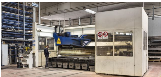
Multitalent: Mit der Laserzell 1005 schweißt und schneidet ELFIM nicht nur 2-D- und 3-D-Bauteile, sie eignet sich auch fürs Laserauftragsschweißen. Bild: Antonio & Roberto Tartaglione
