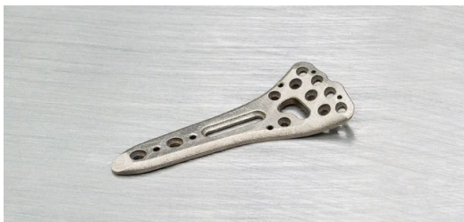
Radiusplatten aus amorphem Metall druckt Heraeus Amloy auf der TRUMPF TruPrint 2000. Individuelle Implantate aus dem 3D-Drucker werden die Medizintechnik revolutionieren. Da ist sich Valeska Melde, Head of Marketing and Sales bei Heraeus Amloy, sicher.
