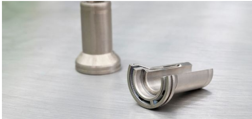
Amorphe Metalle entstehen durch Schockfrostern von Schmelze. Die Atome erstarren ungeordnet und bilden kein kristallines Gitter.
