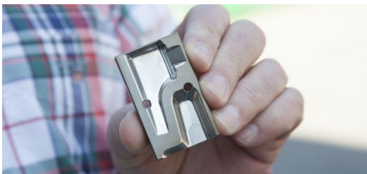
Der Formgreifer zwingt die Rohlinge in eine definierte Lage und damit ins Bezugssystem der Lasermaschine. Bild: Ralf Kreuels
