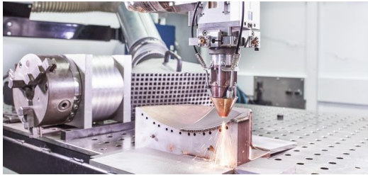
Auftrag wird ausgeführt: Ein TRUMPF Laser trägt auf ein Werkzeug für eine Presse in der Automobilindustrie eine Metallschicht auf.
