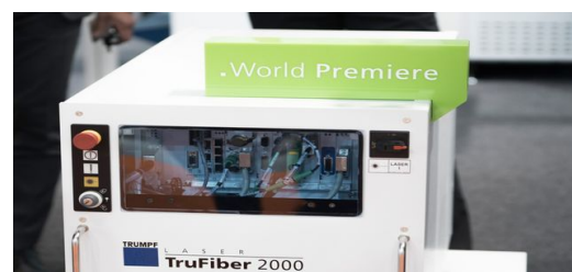
Der faserbasierte Festkörperlaser TruFiber 2000 feierte auf der LASYS 2018 Weltpremiere. Auch er trägt durch den kompakten Laseraufbau und den flexiblen Schnittstellen zu allen gängigen Feldbussystemen und der höchstmöglichen Lasersicherheits-Klassifizierung mit Performance Level e zu einer einfachen Integration bei. Foto: Lorenz Buchwald
