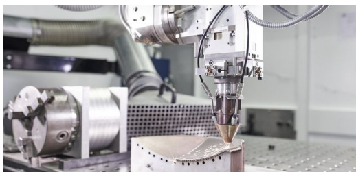
<p>Die hier gezeigte LMD-Technologie eignet sich in der Luft- und Raumfahrt für die Reparatur großer Bauteile. (Quelle: TRUMPF / Claus Morgenstern). </p>
