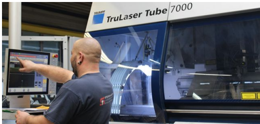
<p>Der Maschinenbediener bekommt das fertige Programm auf sein Terminal, um das Gewinde ins Rohr zu schneiden.</p> – Peter Klingauf
