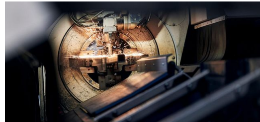
Features wie direktes Editieren, die Möglichkeit zur Simulation sowie die automatische Programmierung von NC-Programmen auf Basis der 3D-CAD Konstruktion in Tube Design stellen sicher, dass 99 Prozent aller Teile, ohne Bedieneingriff so aus der Maschine laufen, wie es sein muss. (Bild: Stefan Hobmaier)
