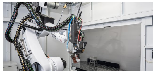
Das Lernetzwerk mit einer TruLaser 3030 fiber und einer TruLaser Robot 5020 erweitert das Portfolio von SCS um Laserschneiden und -schweißen. Bild: Peter Oppenländer
