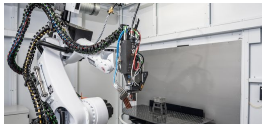
Das Lasernetzwerk mit einer TruLaser 3030 fiber und einer TruLaser Robot 5020 erweitert das Portfolio von SCS um Laserschneiden und -schweißen. Bild: Peter Oppenländer
