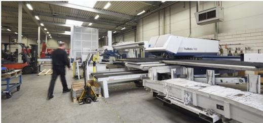
Das Unternehmen bietet eine hohe Fertigungstiefe. Biegen und Schweißen gehören ebenso zum Portfolio wie Laserschneiden und Stanzen – beispielsweise mit der Stanz-Lasermaschine TruMatic 7000 (Foto: Claus Langer).
