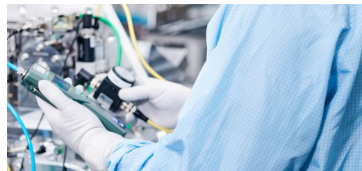
<p> Licht aus CO 2 -Lasern benötigt Unterdruck. Beim Lecktest prüft ein Mitarbeiter, ob Luft von außen in die Anlage eindringt.</p>
