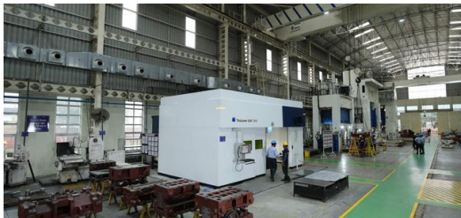
Ursprünglich für den Prototypenbau gekauft, nutzt JBM seine TruLaser Cell 7040 jetzt für das Bearbeiten von Bauteilen aus hochfestem Stahl.
