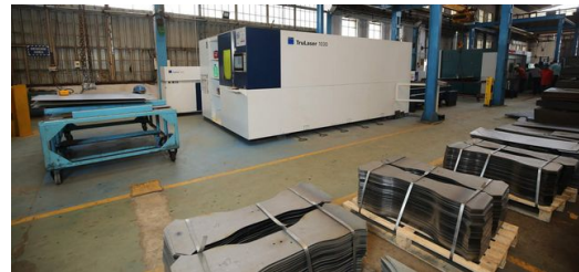
JBM nutzt die TruLaser 1030 Maschinen seit mehreren Jahren für das Schneiden von Blechen.
