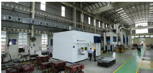
<p>Ursprünglich für den Prototypenbau gekauft, nutzt JBM seine TruLaser Cell 7040 jetzt für das Bearbeiten von Bauteilen aus hochfestem Stahl.</p>
