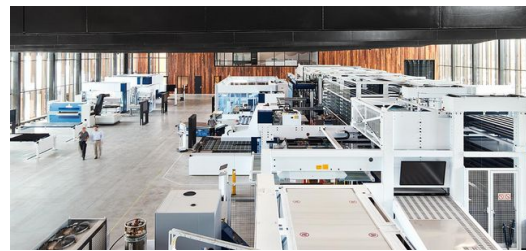
In einer 55 Meter langen Produktionshalle befindet sich eine verkettete Blechfertigung mit einem Hochregallager als Herzstück, das die daran angebundenen Werkzeugmaschinen mit Material versorgt. (Foto: Steve Hall © Hall+Merrick)
