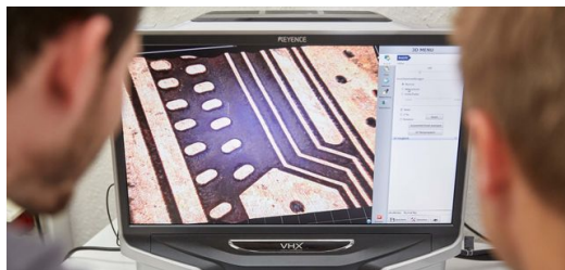
Bei der Sichtprüfung wird der homogene Abtrag dokumentiert. Die Abtragzone ist dunkel und zeigt die Kunststoffoberfläche. In der Bearbeitung kommt es darauf an, die Zwischenräume rückstandsfrei abzutragen, um eine elektrische Isolation zu erreichen. (Bild: Claus Langer)
