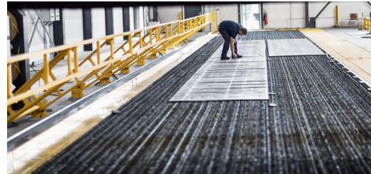
Da der Tisch der Laseranlage ist ebenerdig ist, lassen sich die Bleche gut und einfach einbringen (Bilder: Norbert Voskens).
