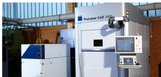
„Die Kantenqualität ist mit dem Werkzeug Festkörperlaser auch bei dickeren Materialien genauso gut wie mit dem CO 2 -Laser“, unterstreicht Franz Biegert, LICOS Trucktec. Bild: Florian Bilger Fotodesign
